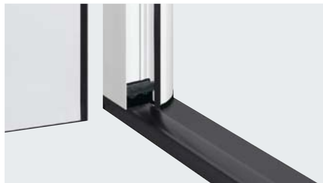
Podwójne uszczelki z dodatkowym uszczelnieniem szczotkowym w obszarze progowym chronią przed wiatrem i opadami.
