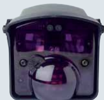
Radarowy czujnik ruchu i rozpoznawania obecności wersja Comfort Radarowy czujnik ruchu i czujnik rozpoznawania obecności na podczerwień. Szybka i celowa funkcja automatycznego otwierania bramy. Niezawodne zabezpieczenie przedpoła. Wysokość maks. 6 m. Przy dużej wilgotności powietrza i na zewnątrz tylko możliwość zastosowania czujnika radarowego. Obudowa: stopień ochrony IP 65
