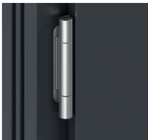
Zawias Premium Simonswerk serii 4000 • regulacja 3D • nośność 160 kg • wzmoconiony antywłamaniowo • gwarancja działania 30 lat (200 tys. cykli)
